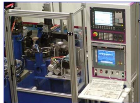
Die Steuerungsanlage besteht aus der CNC-Steuerung SINUMERIK 840 D und dem Umrichter-System SIMODRIVE 611. Die zentralen Steuerungsfunktionen werden von der in der SINUMERIK 840 D integrierten, PLC 315-2DP (vergleichbar der S7-315 DP) realisiert. Der Signalaustausch mit den Sensoren und Aktoren des Prozesses erfolgt sowohl über die integrierte E/A-Peripherie als auch über Profibus DP.
