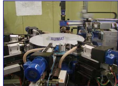
Die Daten werden automatisch durch Vernetzung oder mehrere Datenträger übernommen, dementsprechend werden die Schlüssel hinsichtlich Profil und Stückzahl gefräst.
